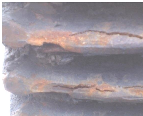
Рисунок 2.1 – Разрушения зуба привода шаровой мельницы
