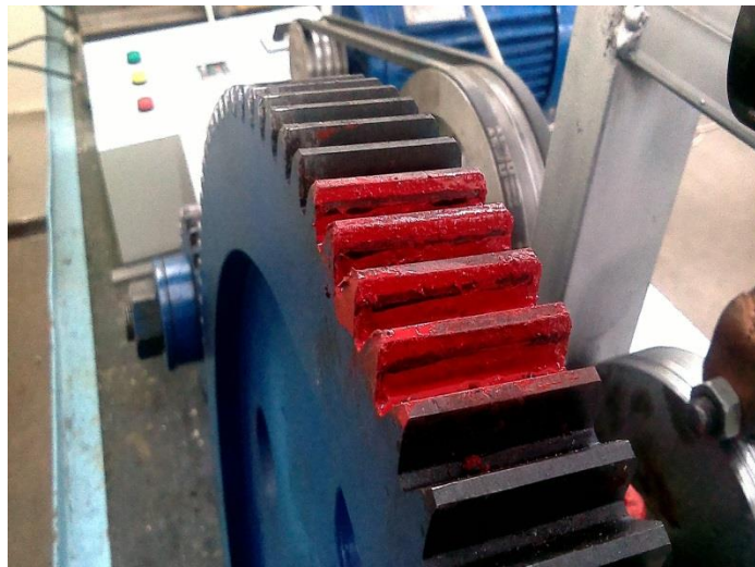
Рисунок 3.23 – Расположение пятна контакта на зубьях цилиндрического колеса
